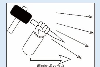
ノミ痕と掘削の進行方向
