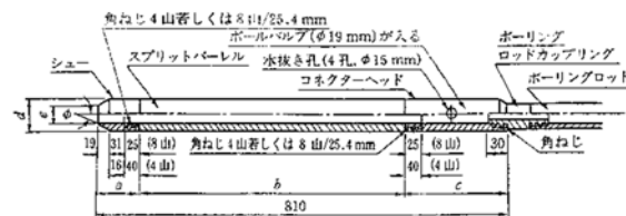
図 3-2-1 標準貫入試験図
