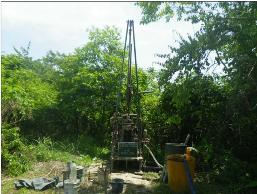
写真区分: No. 3 工種: 全景 写真タイトル: 全景(標準貫入試験)
