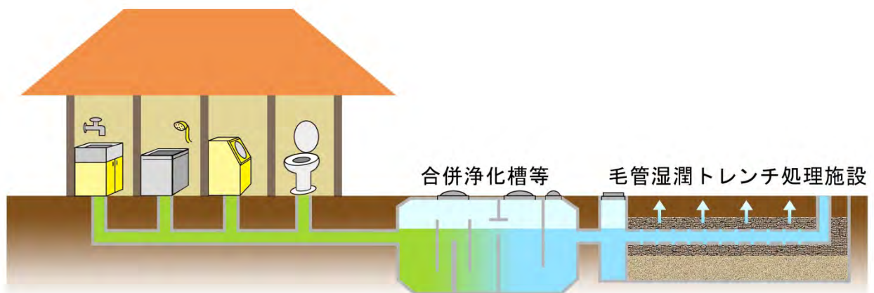
簡易雑排水処理施設と毛管浸潤トレンチ処理施設図
