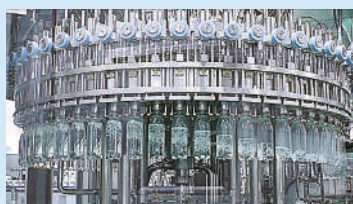
▲ 飲料水充填の様子
