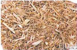
パーティクルボード（PB）の 主原料であるリサイクルチップ （写真提供：永大産業株式会社）
