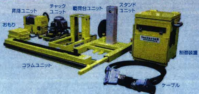
※1ブロックの質量は25kg以下 ※一般的なバンタイプ車積載可能 ※組立時間は2分以内(1人で対応した場合)
