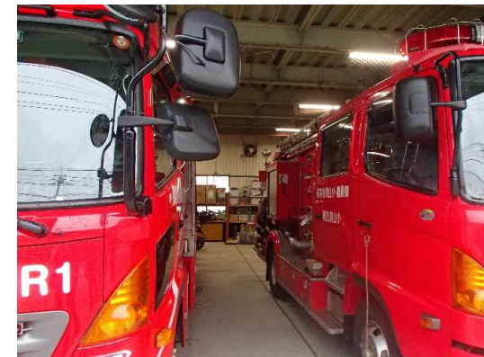
○車両間隔が狭く、乗降りが困難なため、広い駐車スペースを確保する。
