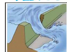
大雨のとき、ため池の水位が上昇し、堤防を越えた水の勢いによって堤防が侵食され、決壊することがあります。流木が洪水吐の断面をふさぐと、堤防を越流しやすくなり、侵食・崩壊の可能性は一層高くなります。
