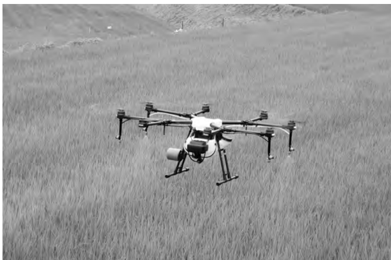
農薬散布用ドローンの試験飛行(湯船地区)
